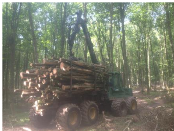
Slika 5. Izvoženje drvnih sortimenata
